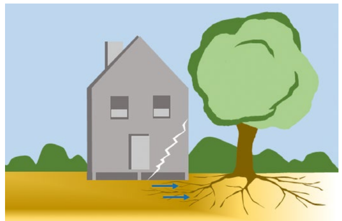
Bäume in unmittelbarer Nähe des Gebäudes können dem Baugrund Wasser entziehen, was zu Schäden am Gebäude führen kann.
