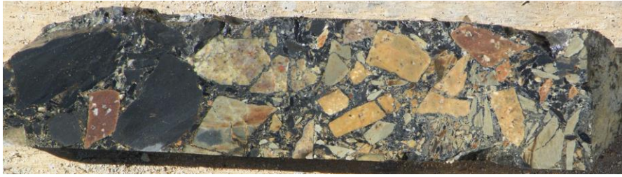
Abbildung 4: Geschnittener Bohrkern aus dem Karbonatitkörper Storkwitz: eckige Trümmer verschiedener explosiv brekziierter Nebengesteine werden durch feinkörnige Karbonatmasse verkittet; Bildbreite etwa 30 cm (Foto: PETER SUHR)
