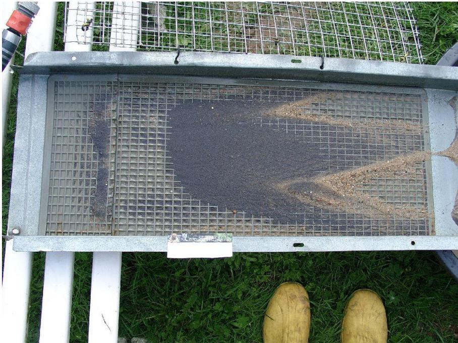
*Abb. 2: Rinne mit eingelegter Matte (hier: Auto-Fußmatte); in diesem Beispiel fließt von links nach rechts Wasser und spült die (meist hellgefärbten) Minerale mit geringer Dichte leichter fort; im Rückstand verbleiben (meist dunkel gefärbte) Schwerminerale (Foto Uwe Lehmann)*
