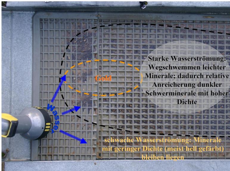
Abb. 1: Prinzip der Goldanreicherung mittels Waschrinne
