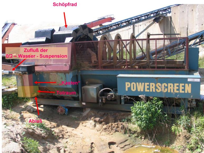
Abb. 7: Probenahmestelle aus einem „Totraum“ im Kieswerk GF1
