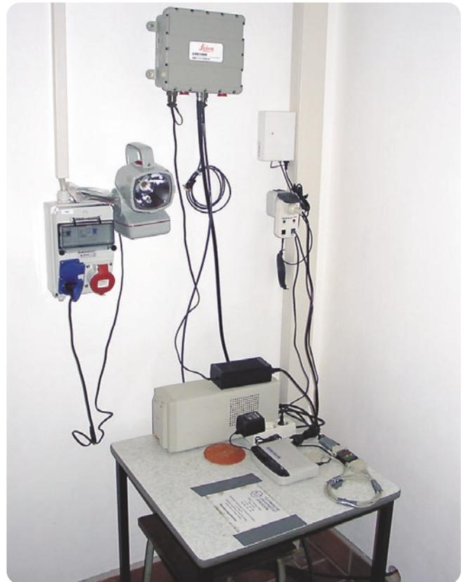
**Abb. 16:** Weitere wesentliche Bestandteile einer der beiden GPS-Permanentstationen. An der Wand hängend ist der GPS-Empfänger montiert. Dieser wird durch eine unterbrechungsfreie Stromversorgung gespeist und ist an eine ISDN-Verbindung für die Datenfernübertragung zur TU Dresden angeschlossen.
