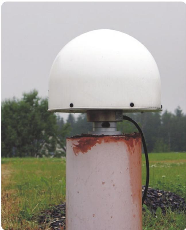
**Abb. 15:** Pfeiler mit Antenne auf einer GPS-Permanentstation. Die Antenne muss fest mit dem Untergrund verbunden sein, und die nähere Umgebung sollte den uneingeschränkten Empfang der GPS-Satellitensignale ermöglichen.
